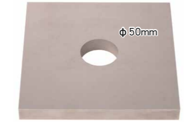
SKD11材20mm厚 \Phi 0.25 黄铜丝 6次加工 \Phi 50mm 真圆度 0.90 \mu m
