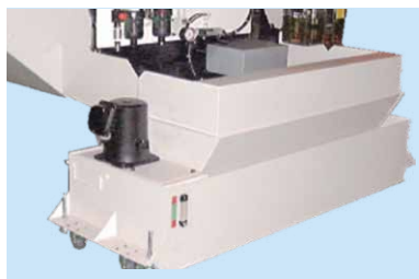
切削液装置 (水槽部分)
