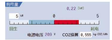
实时显示耗电量和回生电量
