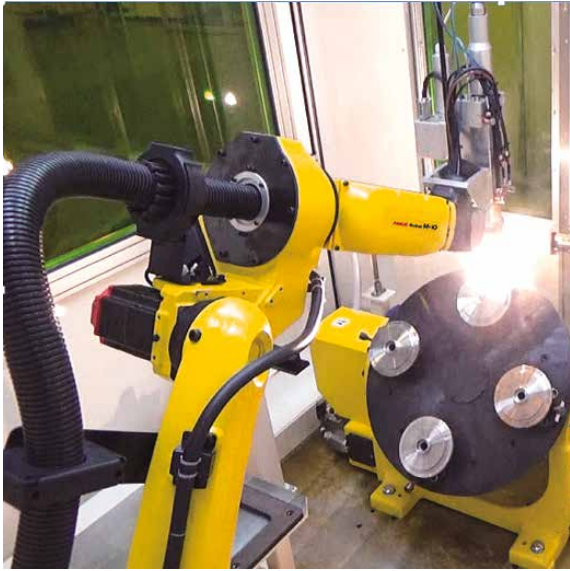
使用双轴变位器的激光焊接
