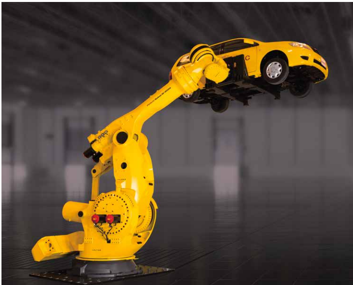
使用M-2000/1700F-47A搬运完成车体
