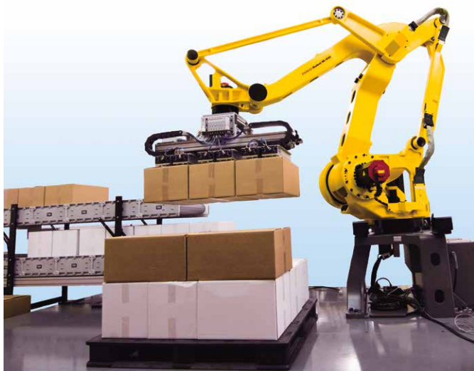
瓦楞纸箱的码垛堆积系统
