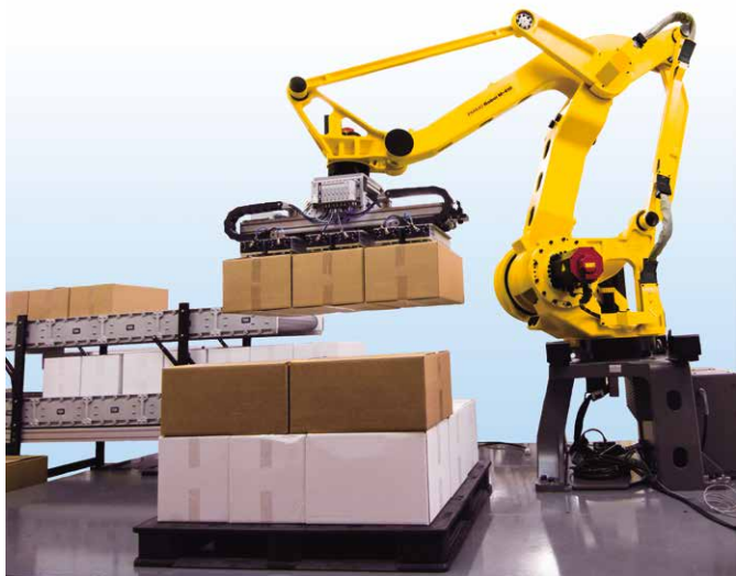
瓦楞纸箱的码垛堆积系统
