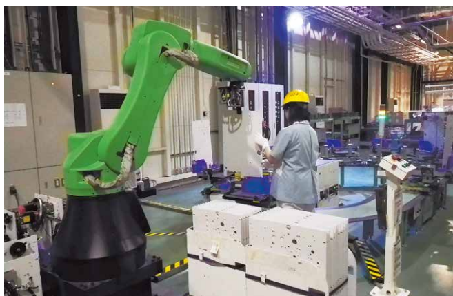
作業者と協働ロボットによるユニット組立て 操作员和协同作业机器人配合完成单元组装
