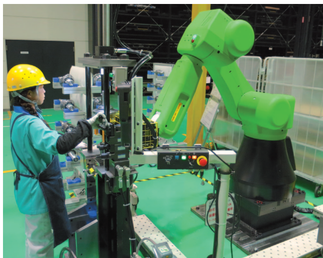
用于 ROBOSHOT 组装工厂的协同作业机器人与人相协作的高效组装系统
