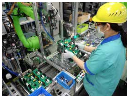
零件配置（作业人员）和拧螺丝（机器人）
