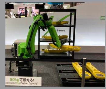
可搬运重量50kg的协作机器人搬运铸件
