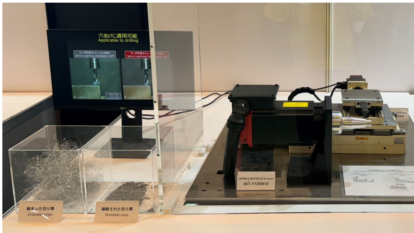
稼働率を向上する切り屑細断機能 (サーボ学習オシレーション機能)
