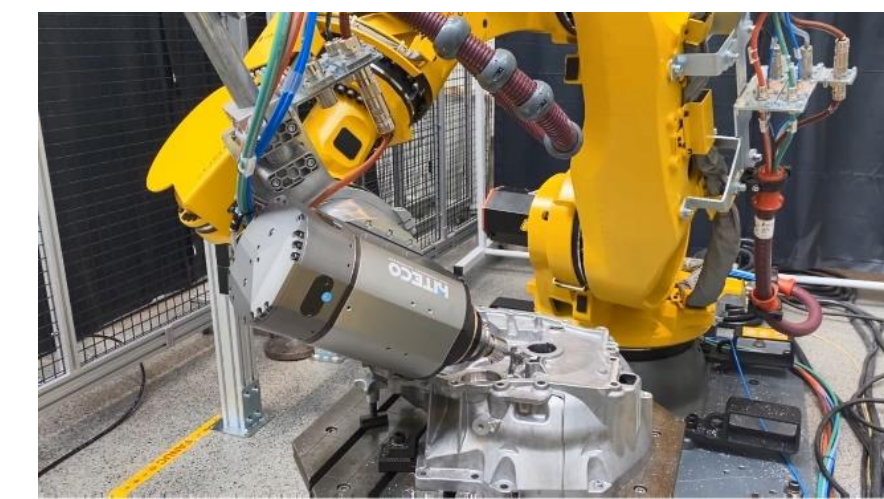
ミッションケースの機械加工
