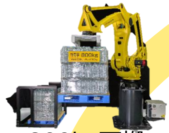
800kg可搬 パレタイジングロボット M-410/800F-32C
