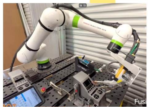
CRXによるレーザー溶接
