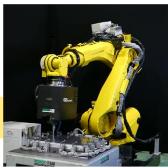
FSW・ミリング加工 R-2000/270F-27C
