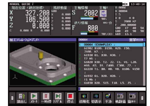
加工シミュレーション画面 (ワークを自由に拡大・縮小・回転)
