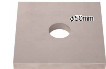
SKD11材20mm厚 φ0.25 黄銅線 6回加工 φ50mm 真円度 0.90μm
