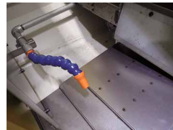
機内洗浄付きクーラント装置 (オイルガン付き)
