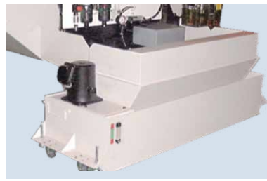
クーラント装置 (タンク部)
