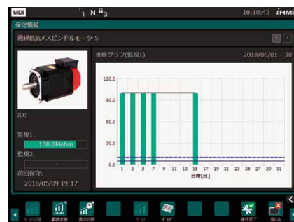
絶縁劣化検出機能画面
