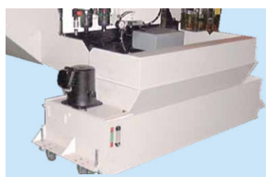
クーラント装置 (タンク部)
