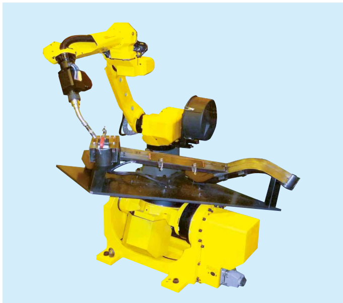
サーボトーチによる自動車部品のアーク溶接
