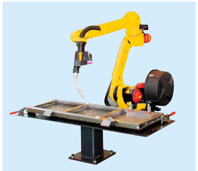
iR Visionを活用した建材部品のアーク溶接
