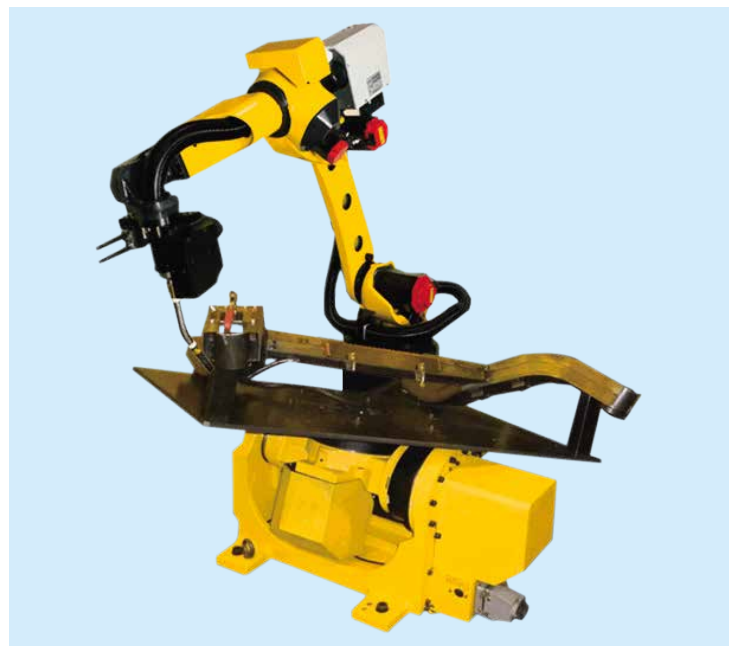
2軸ポジショナを活用した自動車部品のアーク溶接
