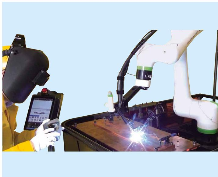
リモコンによる溶接中の電流・電圧の調整
