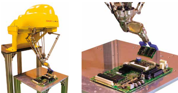
プリント板組み付け
