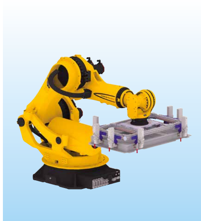
バッテリーユニット搬送 (ロボット後方への搬送)
