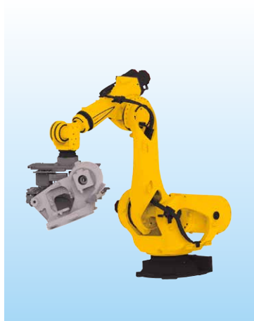
大型鋳物のハンドリング
