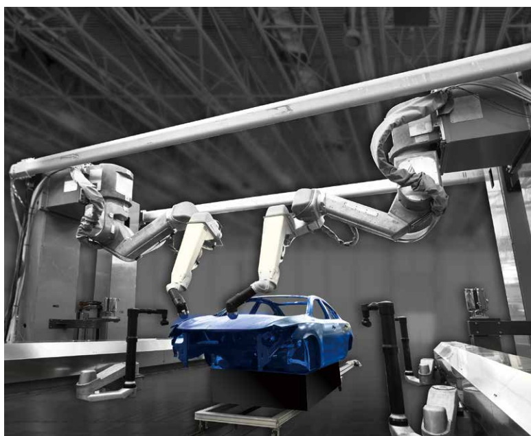
P-1000 i AとドアオープナP-20 i Bによる車体塗装
