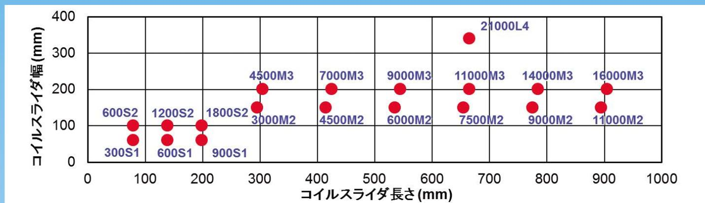
FANUC LINEAR MOTOR L<sup>i</sup>S-B seriesは、最大推力300Nから21000Nまで19モデルの幅広いラインアップです。全てのモデルで400V駆動が可能です。
