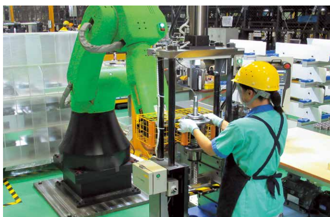
作業者と協働ロボットによるユニット組立 Assembly of a unit by a worker and collaborative robot
