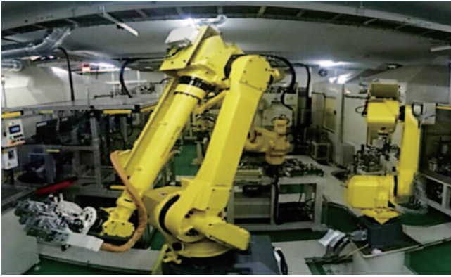
サスペンション溶接ラインにファナックロボットを導入（福島事業所）
