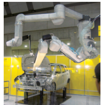
7軸塗装ロボットとドアオープナーを一体化したコンパクトさが好評
