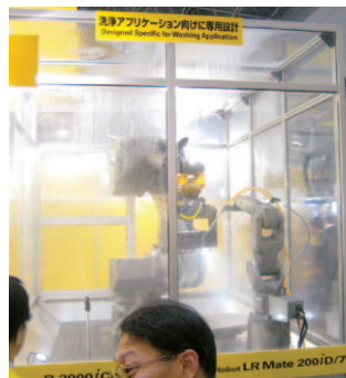
大小2台の洗浄ロボットによる高圧洗浄を実演
