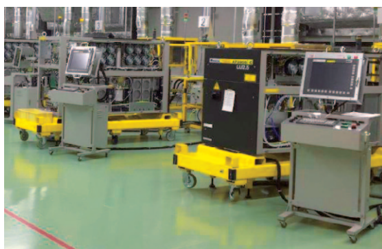
CNCによる炭酸ガスレーザの自動試験(3階)
