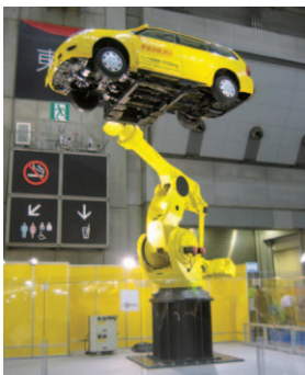
完成車体を高さ6.2m まで持ち上げる力強い動作が好評
