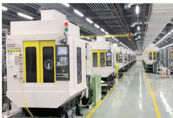
サーボモータ工場 ロボドリルによる部品加工セル
