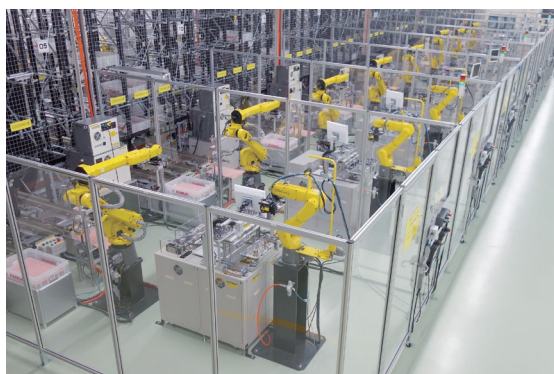
電子工場 プリント板検査セル
