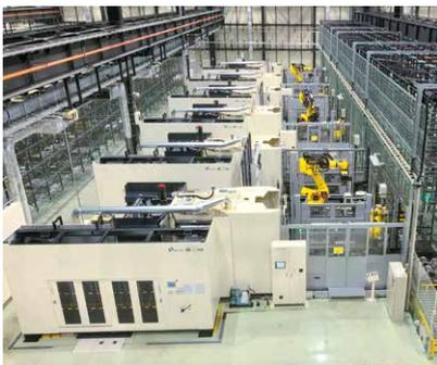
ロボットセルによる機械加工
