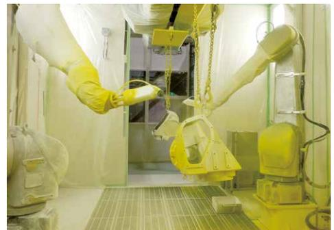
塗装ロボットによる部品塗装
