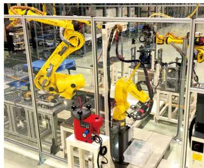
ロボット機構部の自動組立
