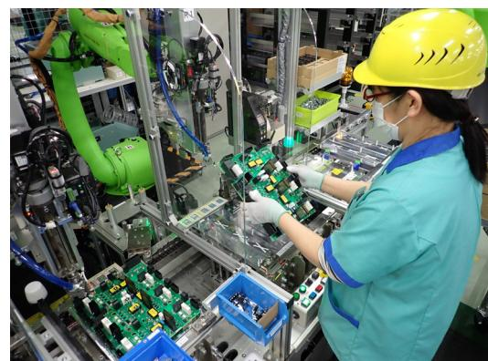
部品配置(作業者)とねじ締め(ロボット)
