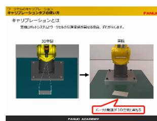
ワークセルと現場のロボットの位置を合わせる方法（キャリブレーション）を説明します。キャリブレーションタブの使い方など
